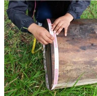
Figura 57. Medición del contorno de la troza
