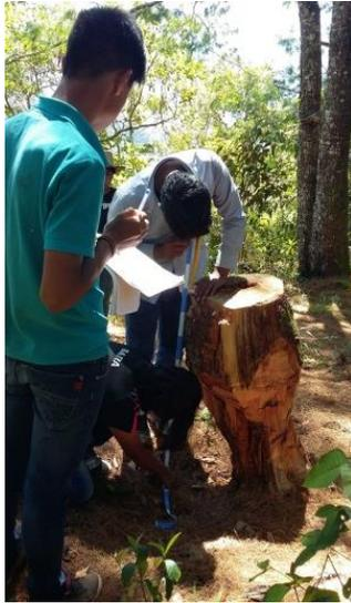
Figura 41. Medida de la altura a la cual se coloca el clinómetro
