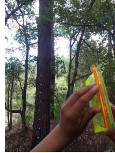
Figura 22. Medida del ángulo para determinar la altura
