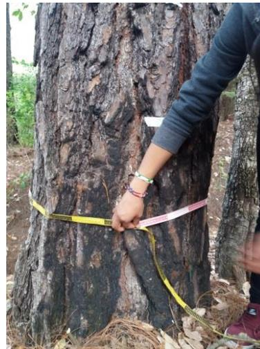
Figura 45. Medida del contorno para la estimación del volumen a cada 30 cm
