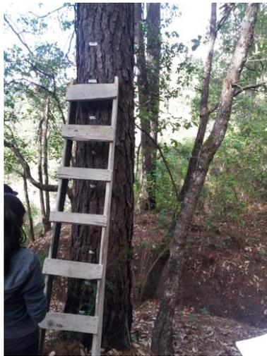
Figura 44. Ubicación de los puntos a cada 30 cm de altura hasta los 2.57 metros
