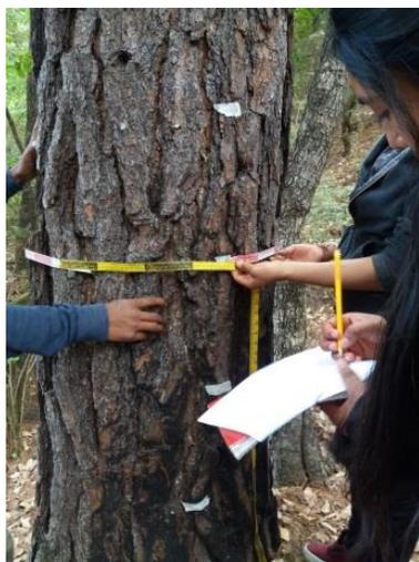
Figura 38. Medida del contorno para calcular el diámetro a la altura de pecho
