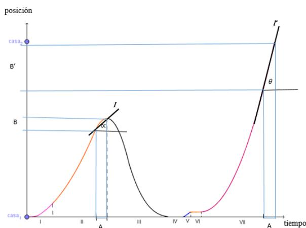
Figura 4.9. Comparación de velocidades con intervalos iguales EQUIPO 9.
