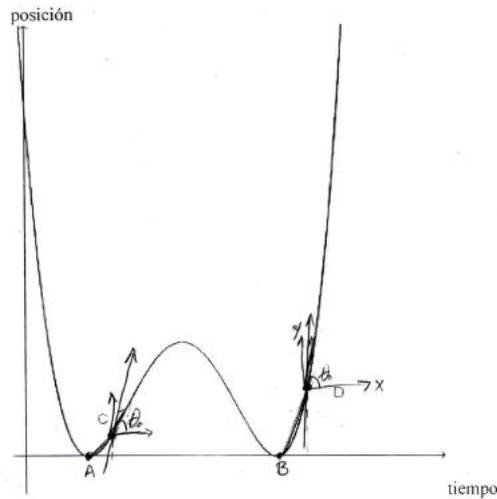
Figura 4.14. Comparación de la velocidad en dos puntos.
