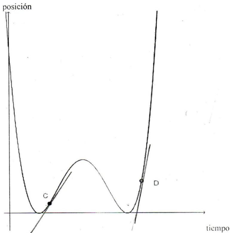
Para poder determinar cómo es la velocidad del punto C respecto al D debemos trazar una tangente en cada uno de los puntos para así determinar la inclinación de la tangente por medio de la pendiente dicha que entre más inclinada sea la recta tiene una pendiente mayor entonces la velocidad en el punto C es menor que en el D.
