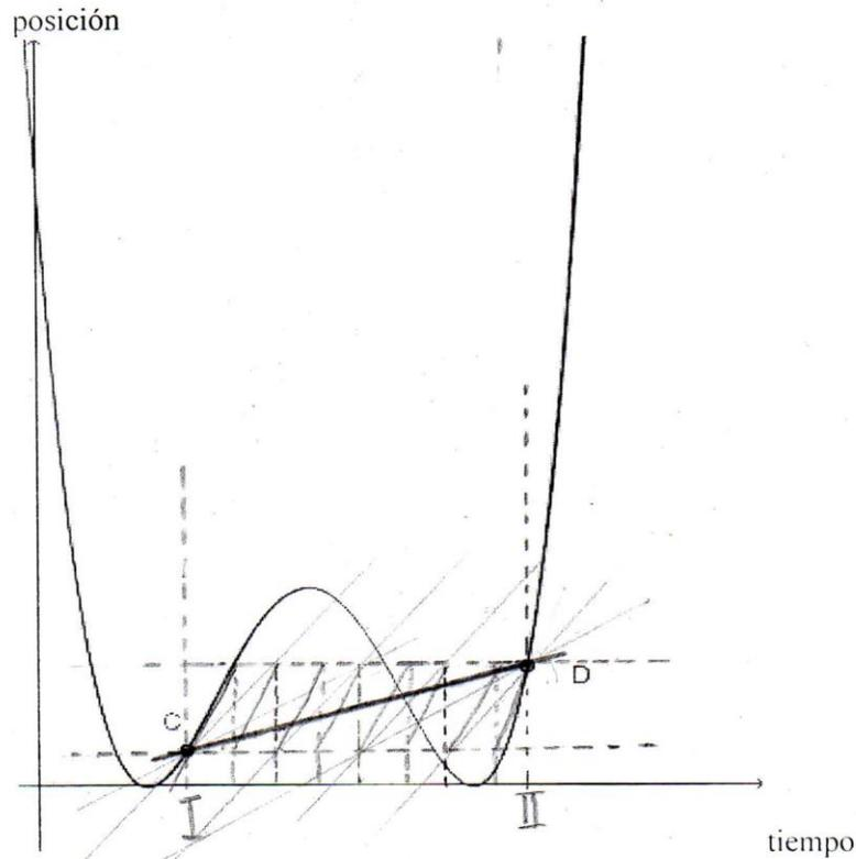
Al trazar dos instantes, I y II, ambos con las mismas condiciones de tiempo y al trazar una recta que toque ambos puntos, después se debe ir dividiendo a la mitad esta recta, se puede observar un cambio de pendiente en cada segmento lo cual representa que la velocidad en el punto C es menor a la del punto D
