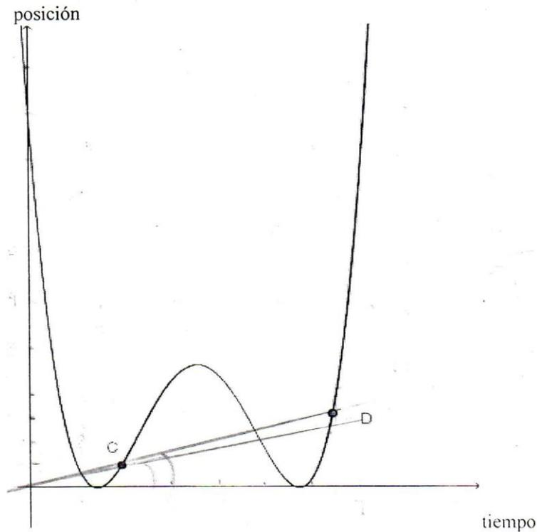
Si trazamos 2 rectas una que uniera al origen con el punto C y otra que lo uniera con D y las comparamos la recta que une al origen con C tiene un ángulo de inclinación menor que el de otra recta por lo que podemos decir que la velocidad en ese punto es menor.
