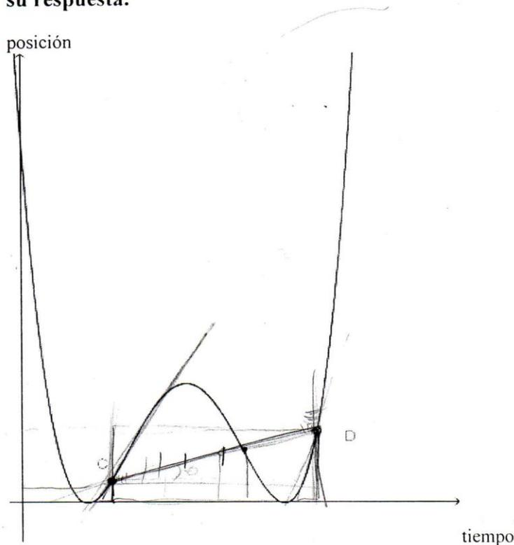
Si trazamos una línea del punto C al D, obtenemos la velocidad constante, una pendiente, siendo así, hubo un cambio de velocidad, algo que no podría ser si no existiera una pendiente, si fuera una constante; otro dato sería las pendientes tangentes que se podría formar con el punto y algún segmento de la gráfica, si son diferentes, unas de otras comprobaría algún cambio de velocidad.
