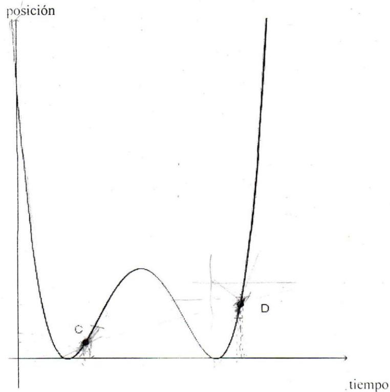
La velocidad en el punto D es mayor que el punto C al trazar una línea de C a D se ve que hay un cambio de velocidad y tiene una pendiente creciente, y la pendiente a la que pertenece el punto C es menor a la pendiente del punto D.
