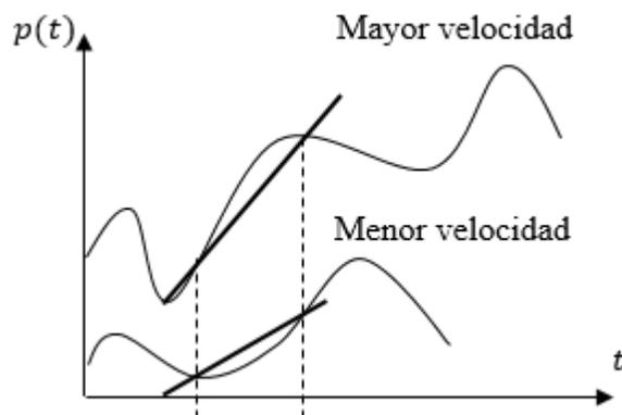
Figura 2.2. Comparación de velocidades utilizando la pendiente
