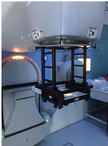
Figura 4.1: Arreglo experimental para mediciones con el detector MatriXX<sup>Evolution</sup> y el software COMPASS
