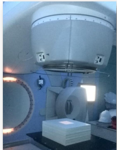
Figura 45. Arreglo experimental para la irradiación del cuadrado de referencia.
