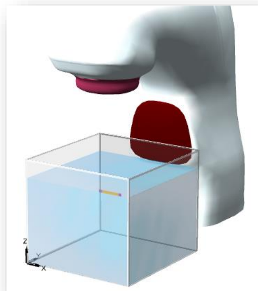
Figura 30. Sentido de escaneo para medición de perfiles de dosis.
