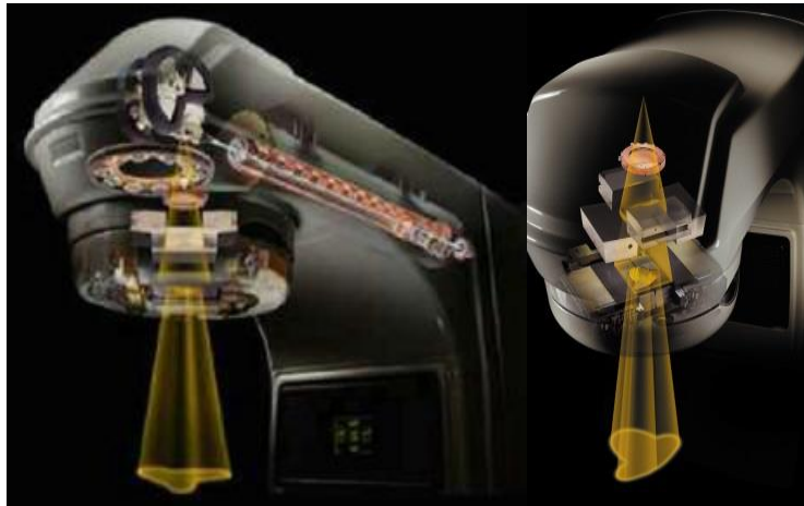
Figura 7. Ubicación del MLC en el gantry del acelerador
