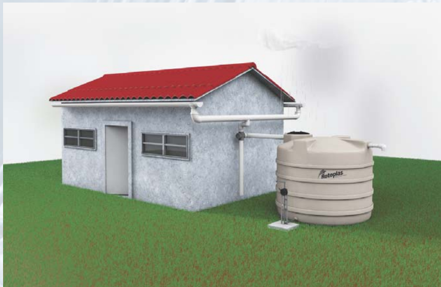
Figura 1: Esquema de un sistema de captación de agua de lluvia [4].
