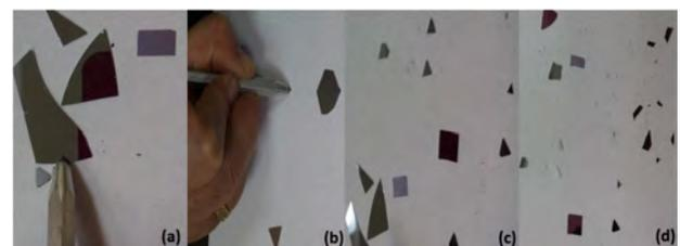
Figura 4: Proceso de clivado de obleas con diferentes orientaciones cristalinas (a y b) muestra clivado de las obleas con un lápiz punta de diamante y (c,d) muestran los cortes de la oblea obtenidos.
