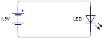
Figura 3 Circuito eléctrico con un led y una batería
