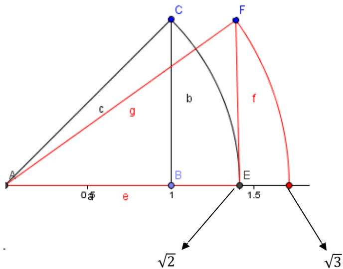
**Figura 7.1.1: Construcción de raíces con regla y compás.**
