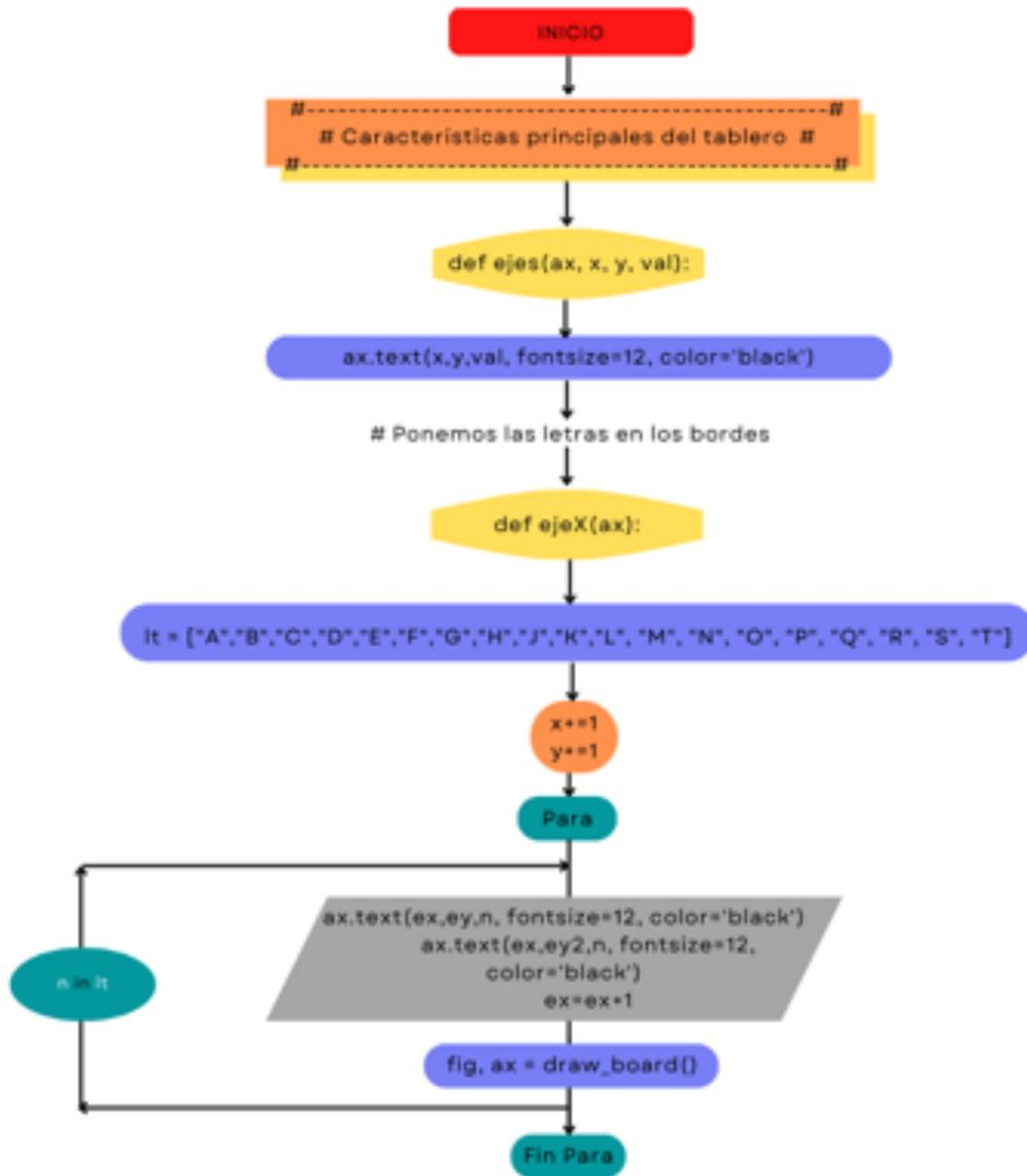
Figura 5.4: Diagrama3: Letras en el borde del tablero.
