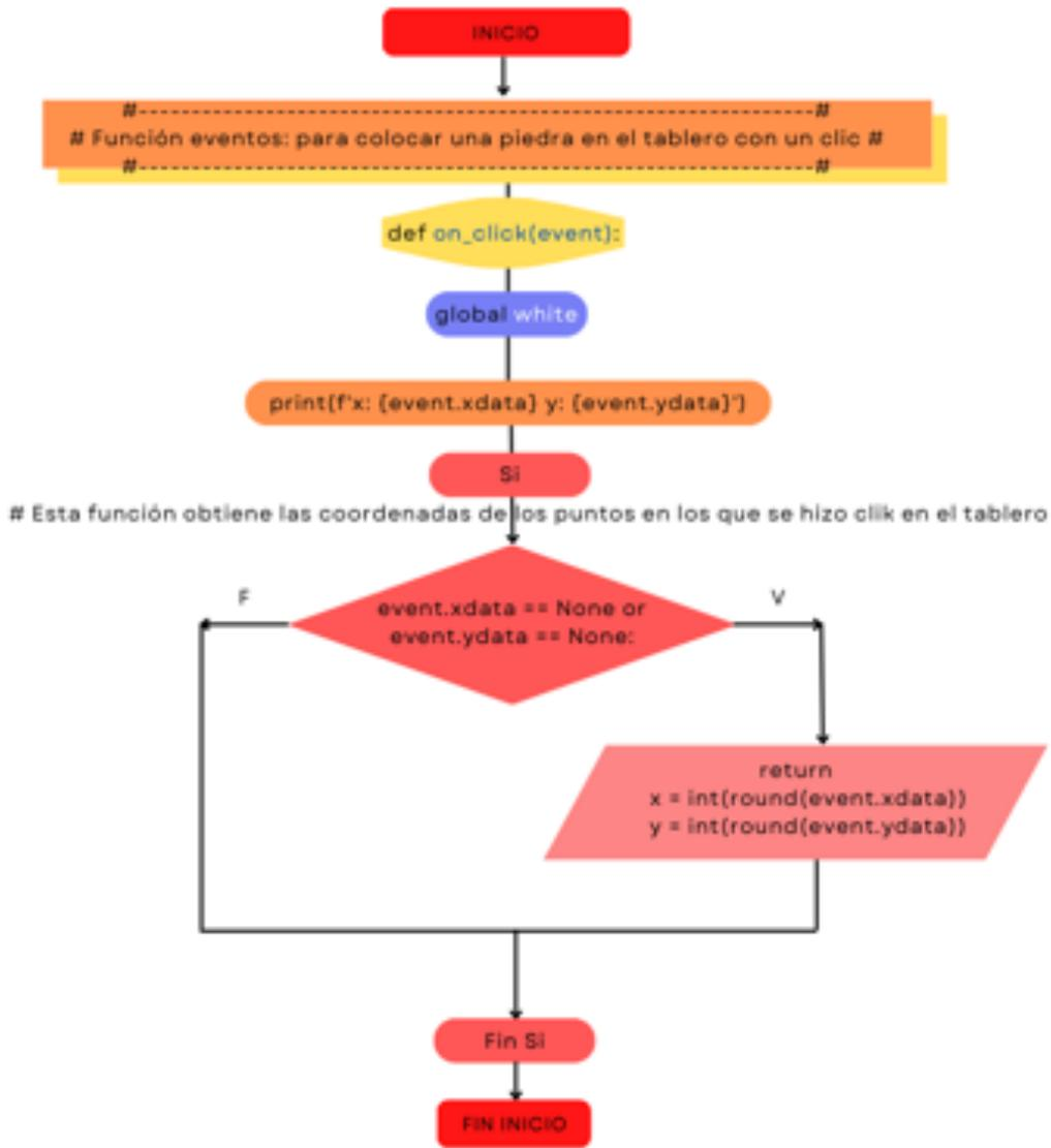
Figura 5.6: Diagrama5: Función *eventos* para colocar una piedra en el tablero.
