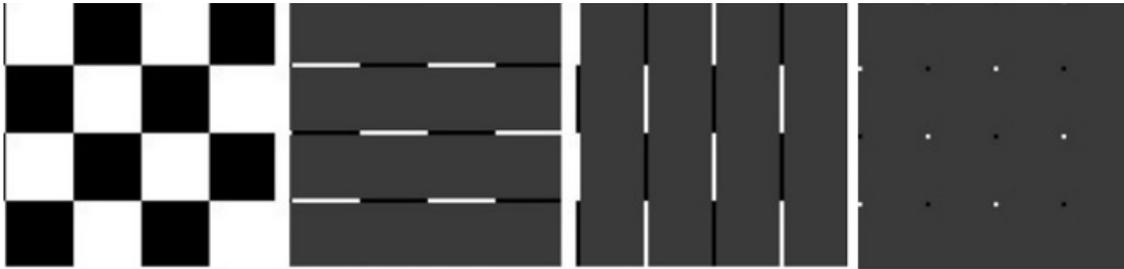
Figura 8: Descomposición en detalles horizontales, verticales y diagonales
