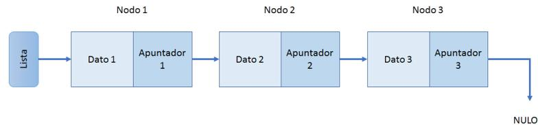
Figura 4.7: Esquema de lista dinámica con tres nodos.
