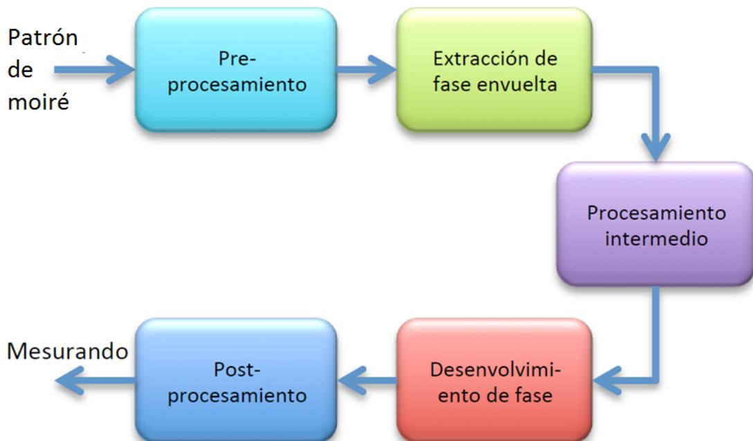
Figura B.3: Estaciones de procesamiento típicas incluidas un bloque de análisis de franjas para extracción de la fase codificada.
