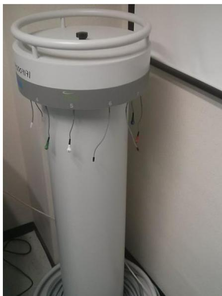
Imagen 23. Torreta con los diodos del sistema InViDos.
