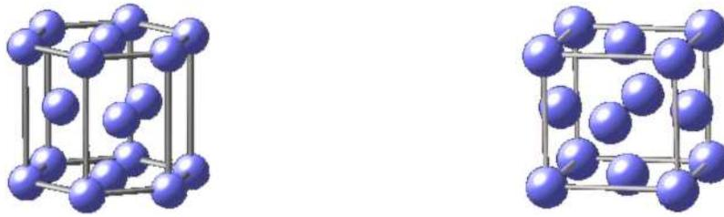
Figura 1.14: Izquierda: celda de la estructura hexagonal, derecha: celda unitaria de la estructura cúbica centrada
