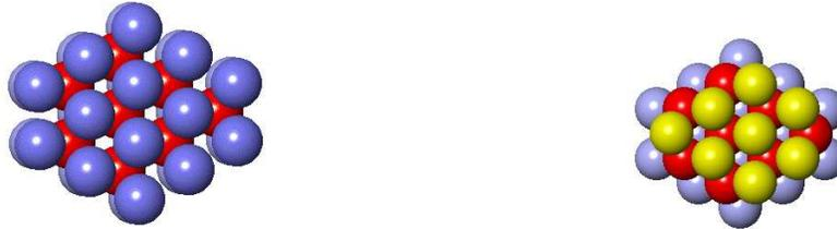
Figura 1.13: Izquierda: capas  $aba$  que corresponde a una estructura tipo hcp, derecha: capas  $abc$  de una estructura tipo fcc.
