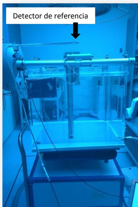
Figura 25. Posicionamiento del detector de referencia.
