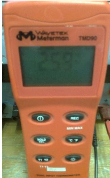
Figura 25 Medidor de temperatura Wavetek.
