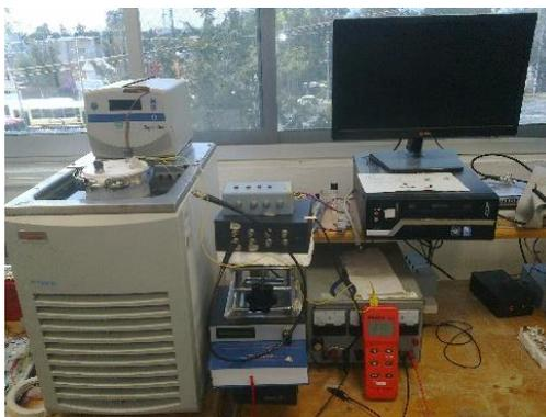
Figura 30. Sistema estático usado para la medición de respuesta de los sensores de gas.
