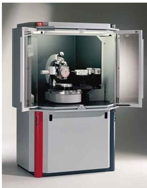
Figura 3.5: Equipo de difracción de rayos X Bruker D8 Discover
