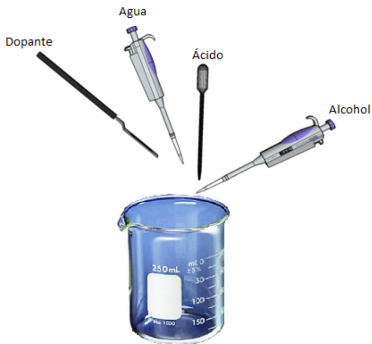
Figura 4.1: Vaso de precipitado con los reactivos para preparar el Vaso 1, éstos son agregados en el orden que se muestra en la figura.
