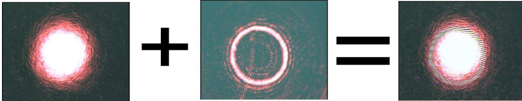
Figura 3.17: Ejemplo de patrón de interferencia entre una onda plana y un vórtice óptico perfecto
