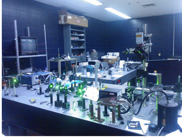
Figura 3.22: Arreglo experimental de pinzas ópticas
