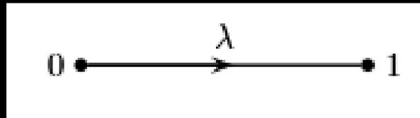
Cuando en el estado 0 espera un tiempo aleatorio con una distribución exponencial del parámetro  $\lambda \in (0, \infty)$ , entonces salta a 1. Así, la función de densidad del tiempo de espera  $T$  viene dada por  $f_T(t) = \lambda e^{-\lambda t}$  para  $t \geq 0$ . Donde  $T \sim E(\lambda)$  por brevedad.
