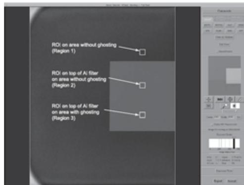
Figura 3.18: Pantalla de mastografía mostrando las regiones en las que se miden los valores de pixel en la prueba de Ghosting
