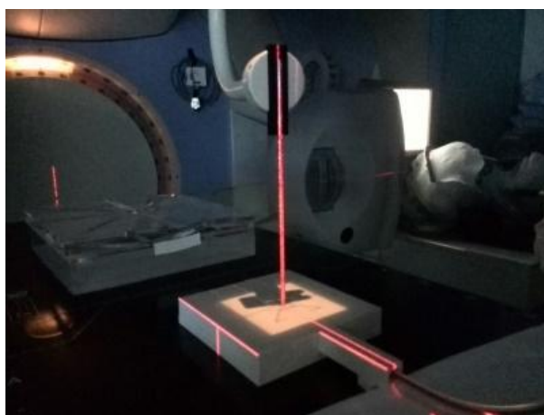
Imagen 25.Alineación del maniquí dentro del campo proyectado por el gantry.
