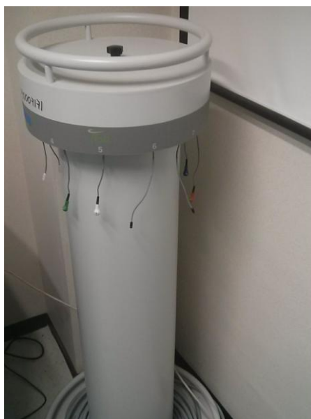
Imagen 23. Torreta con los diodos del sistema InViDos.
