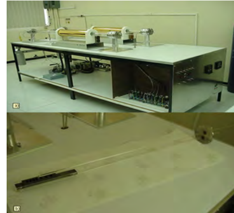
Fig. 6. a) Sistema de epitaxia desde Fase Líquida diseñado y construido en el CIDS-ICUAP. b) Vista del bote deslizante (sliding) y su manipulador en su soporte de cuarzo. (cortesía BUAP) [5]
